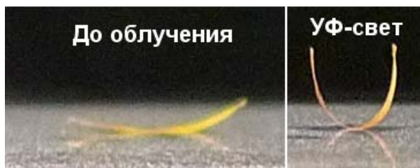
Рис. 1. Светоиндуцированное сгибание плёнки фотоактюатора.
